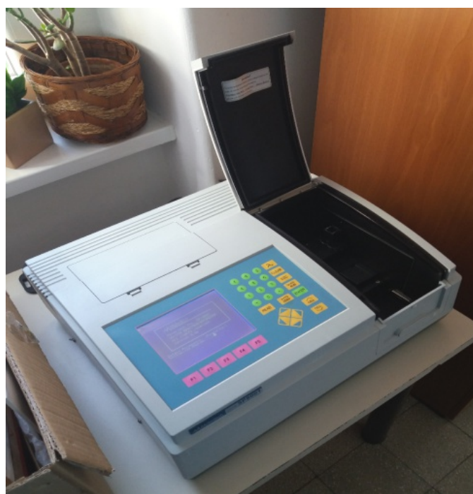
18. kép. Metertech UV-VIS SP8001 típusú spektrofotométer (Fotó: Agócs Attila)
